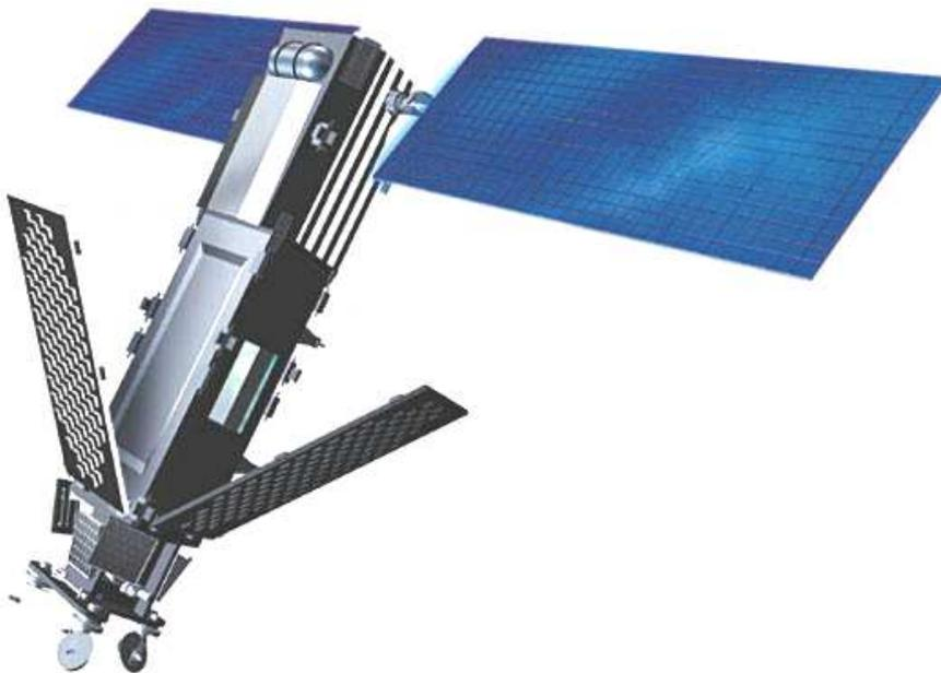
Les satellites sont un corps de forme prismatique à base triangulaire de 1 m de côté et de 4 m de long. De plus, ils comportent deux panneaux solaires pour l'alimentation en énergie et trois antennes pour la réception et la transmission des messages. Ces antennes de 80cm x 2m (Main Mission Antenne) sont
