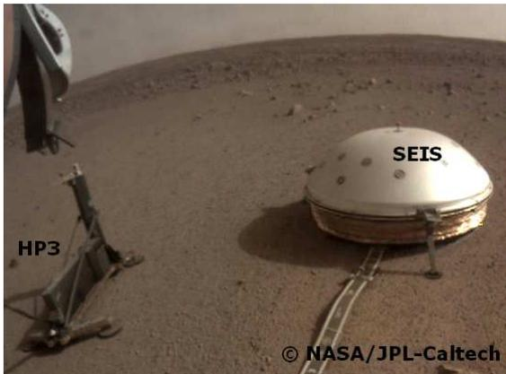
Dix jours après avoir recouvert d'un bouclier thermique le sismomètre SEIS, la sonde InSight a déployé avec succès le 12 février son second équipement, le thermomètre HP3 de construction allemande. Il sera opérationnel dans quelques jours.
