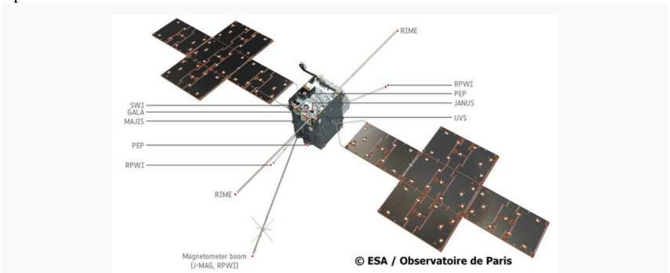
Un mat extensible de 10,6 mètres accueille J-MAG et RPWI et une antenne de 16 mètres de long sera utilisée pour RIME. Enfin quatre mats de 3 mètres supportent des éléments de l'expérience RPWI. Les autres instruments sont montés sur le corps du vaisseau spatial.
