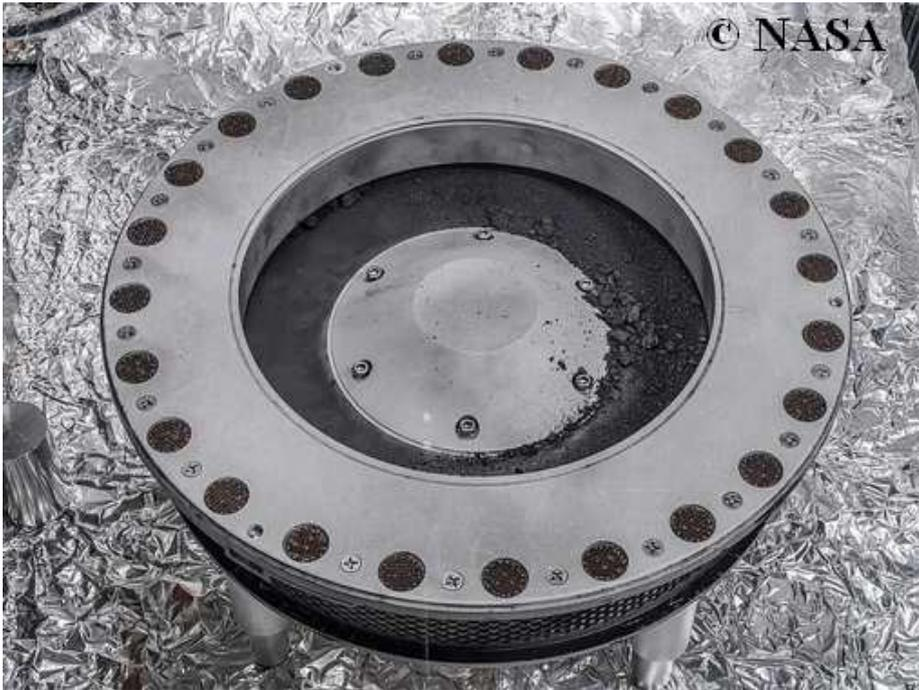
Container de récupération des matériaux de Benu. Une partie est restée à l'extérieur du compartiment de stockage qui contenait environ 250 g de matière extraterrestre.
